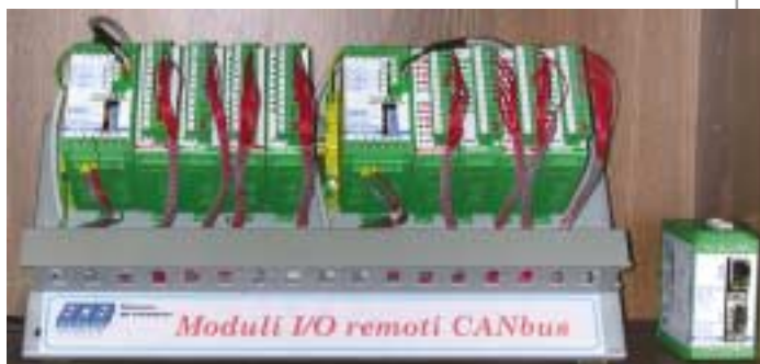
Particolare delle interfacce di campo CANbus per gli I/O da collegare agli apparati e ai controlli numerici di S.C.E.
